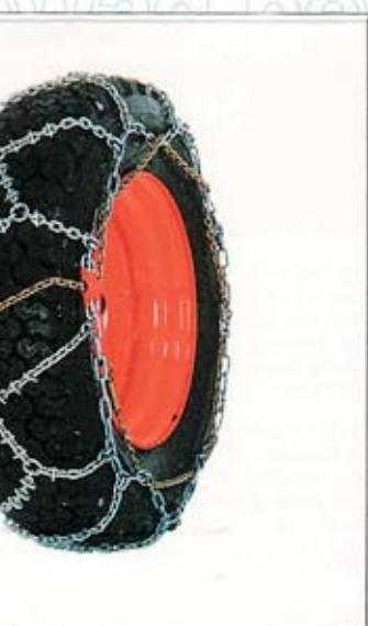
Goldene Spannkette neben Ringverschluß anfassen, von Reifenlauffläche wegziehen, bis sich Ringverschluß hinter dem Reifen schließt.
