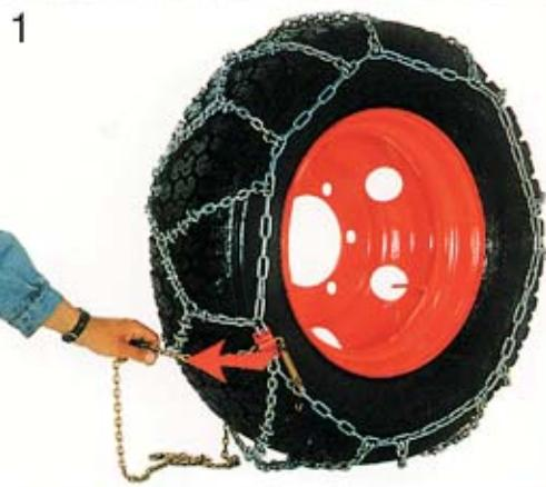
Goldene Spannkette aushängen und durch Verschlußring zurückziehen, Kette lockern.
